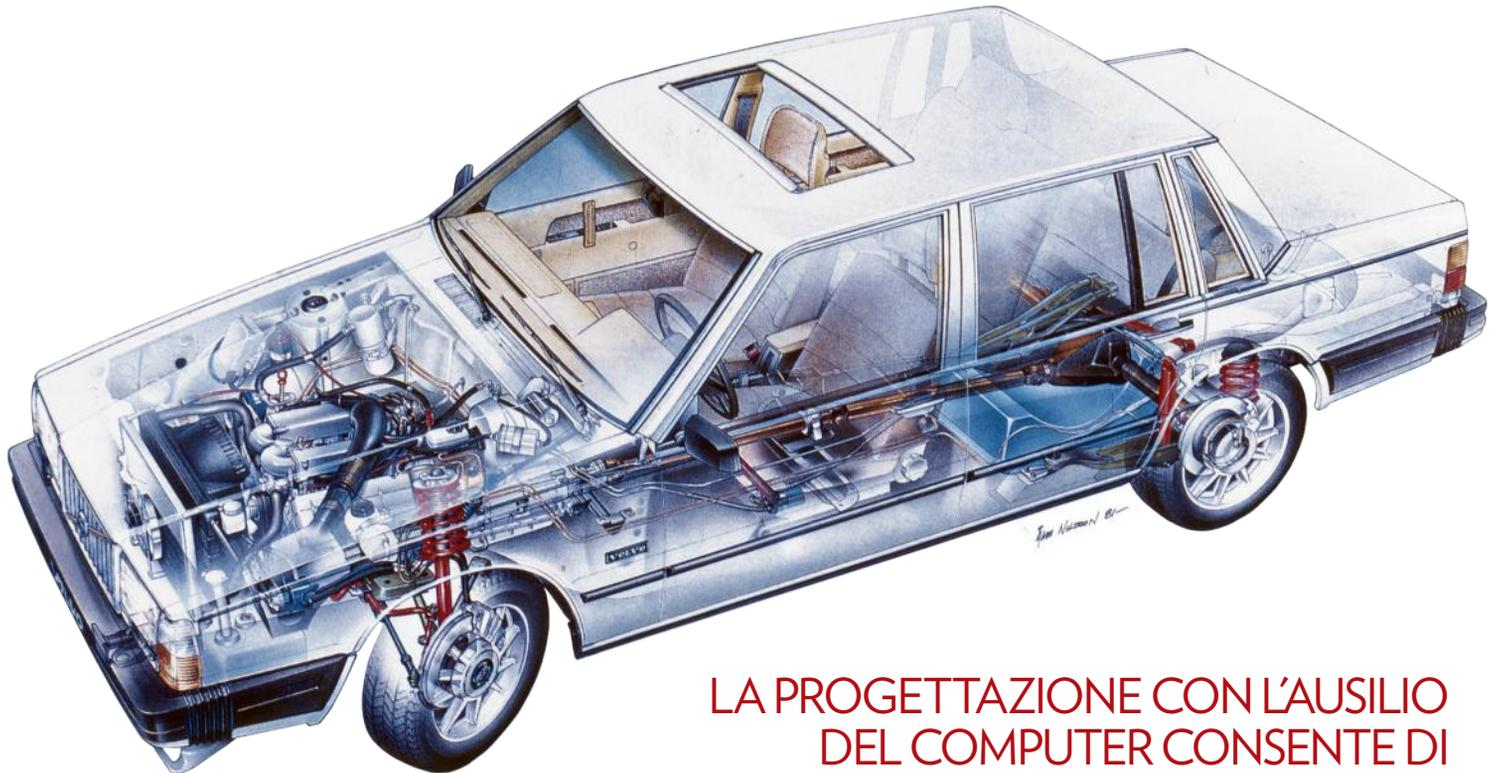
**LA PROGETTAZIONE CON L'AUSILIO DEL COMPUTER CONSENTE DI ALLEGGERIRE LA SCOCCA DI 100 KG RISPETTO A QUELLA DELLA 240**
